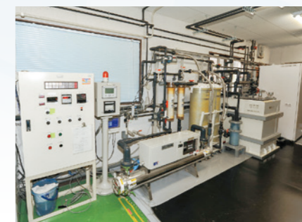
取手事業所 (R&Dセンター) にあります超純水製造装置は、各種センサーの検査や標準試薬の希釈水として最高レベルの基準溶液を作り出すことが可能で、機器類の検査や調整に威力を発揮しています。
