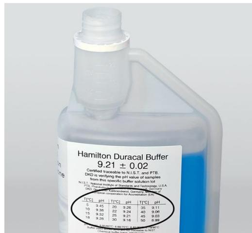
上記の温度表は pH9.21 のデュラキャル pH 緩衝液で、5°C 刻みで 5~50°C の pH 値を示しています。25°C 以外の周囲温度では、表を参照し適切な pH 値をメーター、トランスミッター、またはアナライザーに入力する必要があります。
