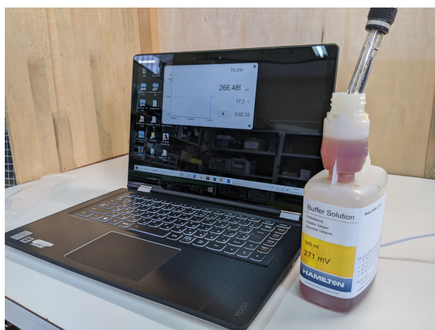
ORP 校正液に浸漬し電極性能を確認している状況
