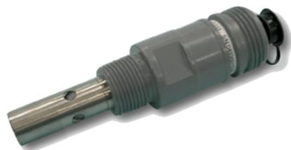
電極にチタン、センサーボディに CPVC 樹脂を用いたケーブル脱着型の 2 電極式比抵抗/導電率センサーです。
