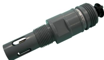
フッ酸対応のケーブル脱着型の 4 電極式導電率センサーです。電極にモネル、センサーボディに PPS 樹脂を採用しています。
