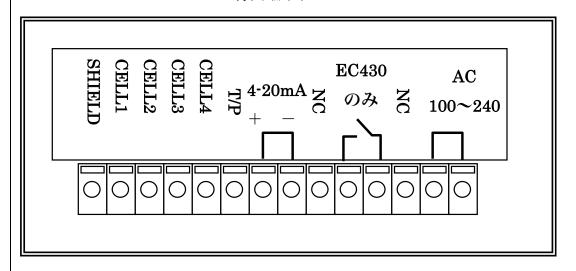
SHIELD : 電極のシールド線を接続します
